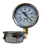
En cas de prise d'air, le pointeur (vide) descend à zéro quand la pompe est à l'arrêt.
